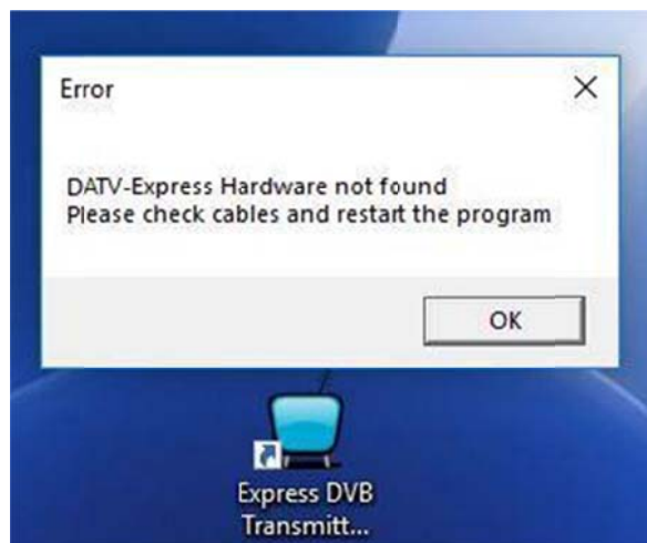
Figure 17 - Un message d'erreur indiquant « matériel DATV-Express introuvable » ou la mention « Aucun matériel PLUTO trouvé », signifie généralement que le MODULATEUR-COMMUNE les paramètres ne sont pas correctes pour LimeSDR
