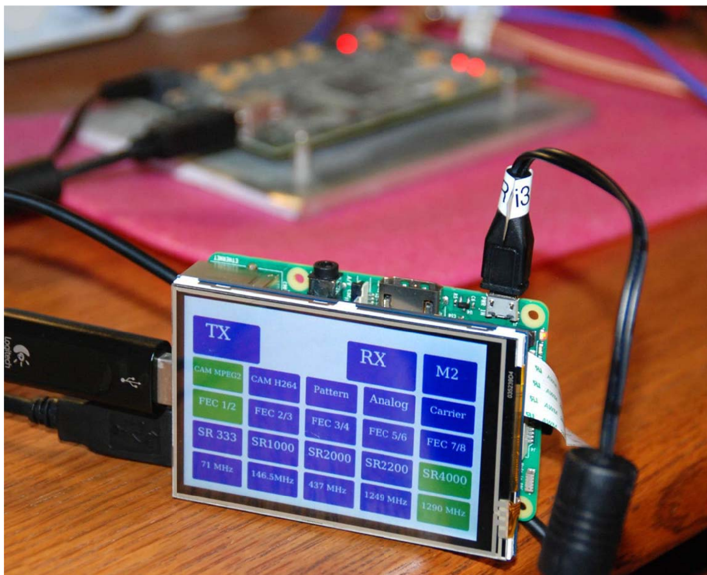
Figure 61 - Utilisation de la carte DATV-Express comme modulateur pour la BATC Portsdown logiciel de projet en cours d'exécution sur un Raspberry Pi-3
