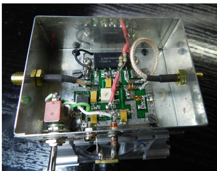
Ampli RA07H4047M, pcb minikit, radiateur et ventilateur Pentium, boîtier Schubert
