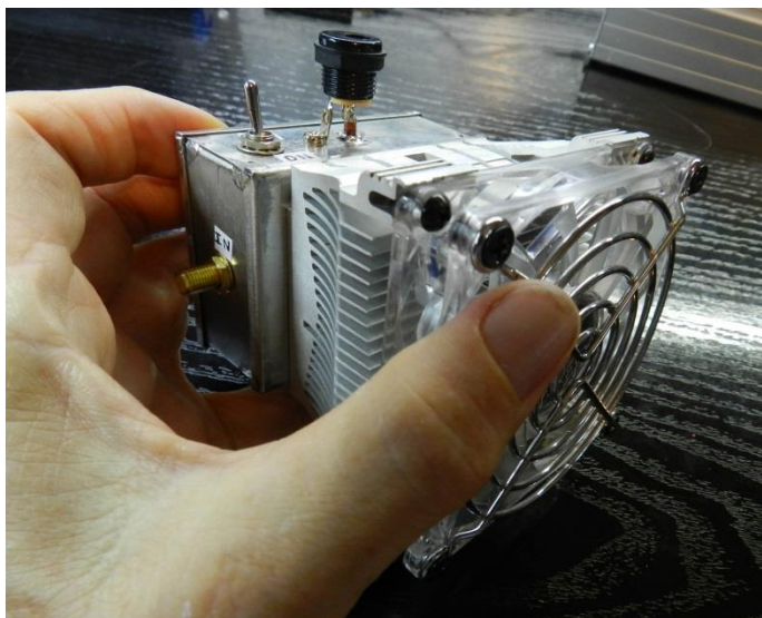
Ampli RA07H4047M, pcb minikit, radiateur et ventilateur Pentium, boîtier Schubert
