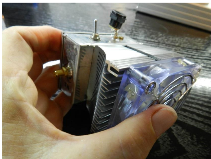
Ampli MHW2723, pcb F1DJO, radiateur et ventilateur Pentium, boîtier Schubert
